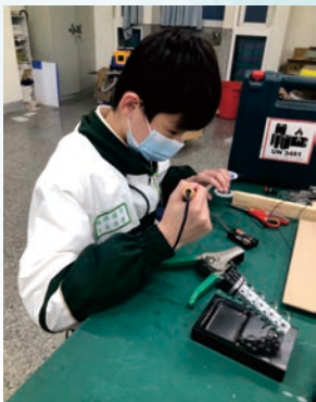
學生使用電焊完成電路連接
